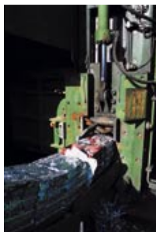
På store shredder anlæg neddeles alle former for jern og skrotbiler i en række fraktioner
