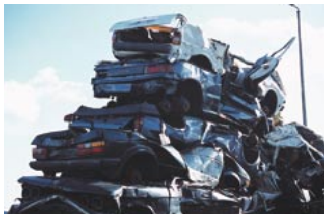
På Uniscraps scredder anlæg neddeles de miljøbehandlede biler i en række genanvendelige fraktioner.
